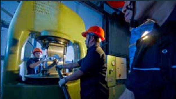
1500 Ton Splicing Machine dari Eropa untuk membuat mata wire rope sampai diameter 76mm
