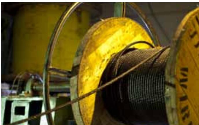
3. Tahukah anda, bahwa penyiapan wire rope yang tidak hati hati dapat menyebabkan Kink & Core wire rope patah sehingga wire rope cepat rusak?
