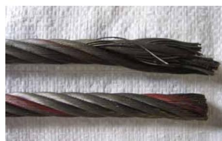
Perbandingan wire rope yang padat dibagian bawah dan wire rope yang renggang dibagian atas
